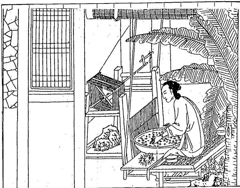
7. Desengomado de los capullos. Calentado en agua y extracción de los hilos de seda.
